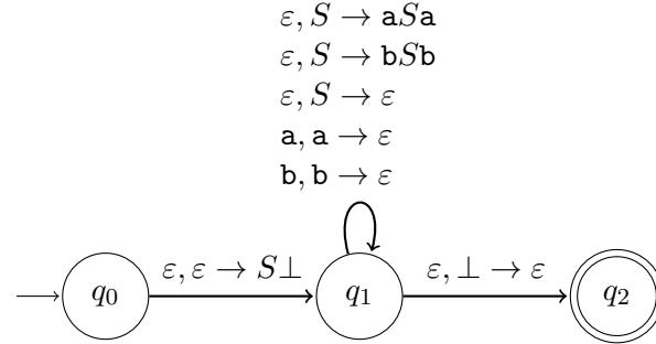
Les trois premières transitions qui bouclent sur  $q_1$  simulent la grammaire lorsqu'une variable est au sommet de la pile. Les deux autres font avancer la lecture du mot d'entrée lorsque des symboles terminaux sont au sommet (à condition que les deux soient identiques). Cet automate acceptera un mot  $w$  si et seulement si  $S \xrightarrow{*} w$  (c.à.d.  $w$  peut être dérivé depuis  $S$ ), ce qui correspond bien à l'objectif.
